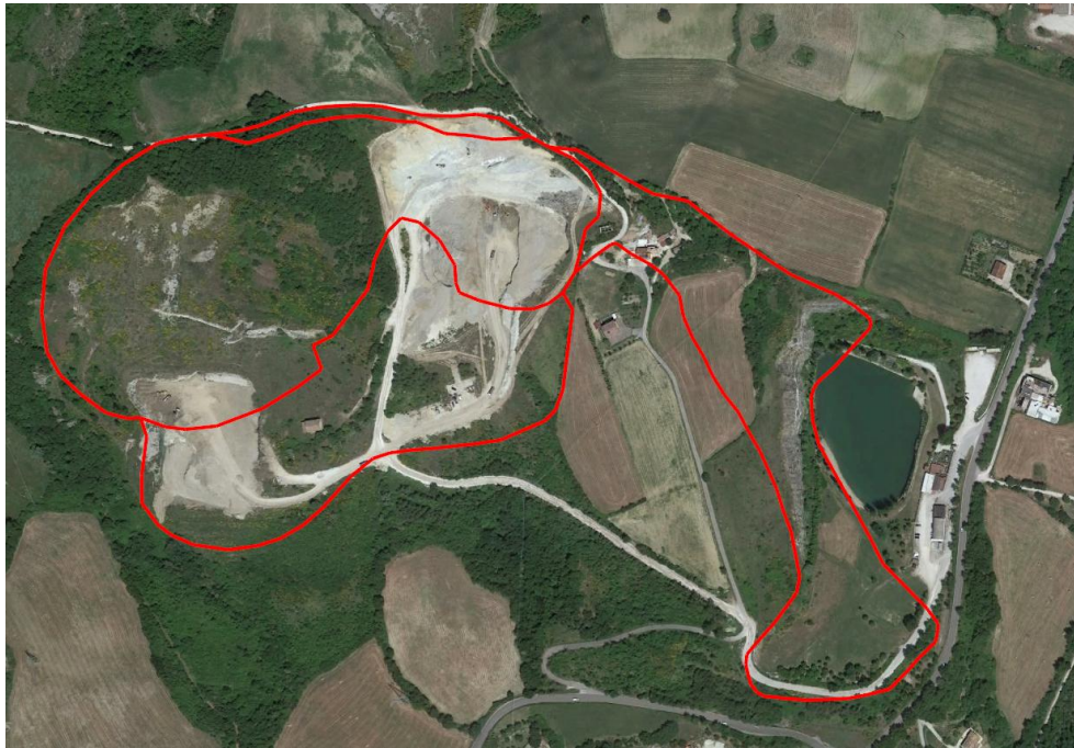
Fig- 24 – immagine Google 2017. In evidenza l’area nella quale sono in corso le attività di scavo (residuali) e sulla sinistra l’area dove sono in corso le opere di sistemazione morfologica. Sulla destra nella foto il sub-ambito 2-2 già sistemato (contermine all’invaso).
