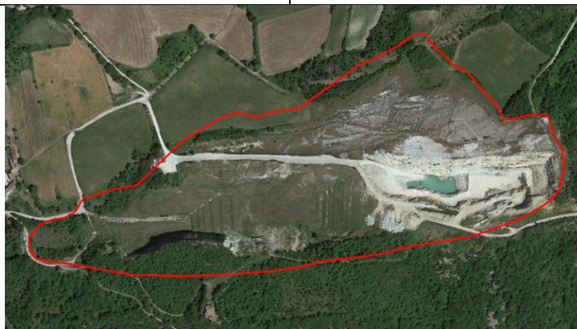
Fig. 5 - UMI SMN003-2 - Google 2017. In rosso il perimetro dell'ambito esteso. L'attività estrattiva futura amplia i quantitativi utili estraibili in una zona già soggetta in passato ad attività estrattiva. Nella foto sono ben visibili i settori nei quali l'attività estrattiva si sta concludendo e dove si sta procedendo con la sistemazione finale.
