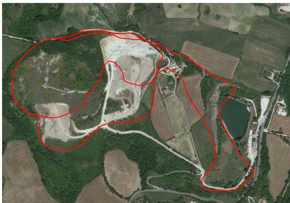
Fig- 30 – immagine Google 2017. In evidenza l’area nella quale sono in corso le attività di scavo (residuali) e sulla sinistra l’area dove sono in corso le opere di sistemazione morfologica. Sulla destra nella foto il sub-ambito 2-2 già sistemato (contermine all’invaso).
